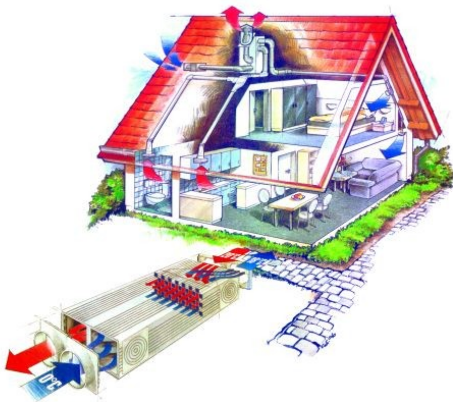
Rysunek 9.4. Wentylacja mechaniczna z odzyskiem ciepła
