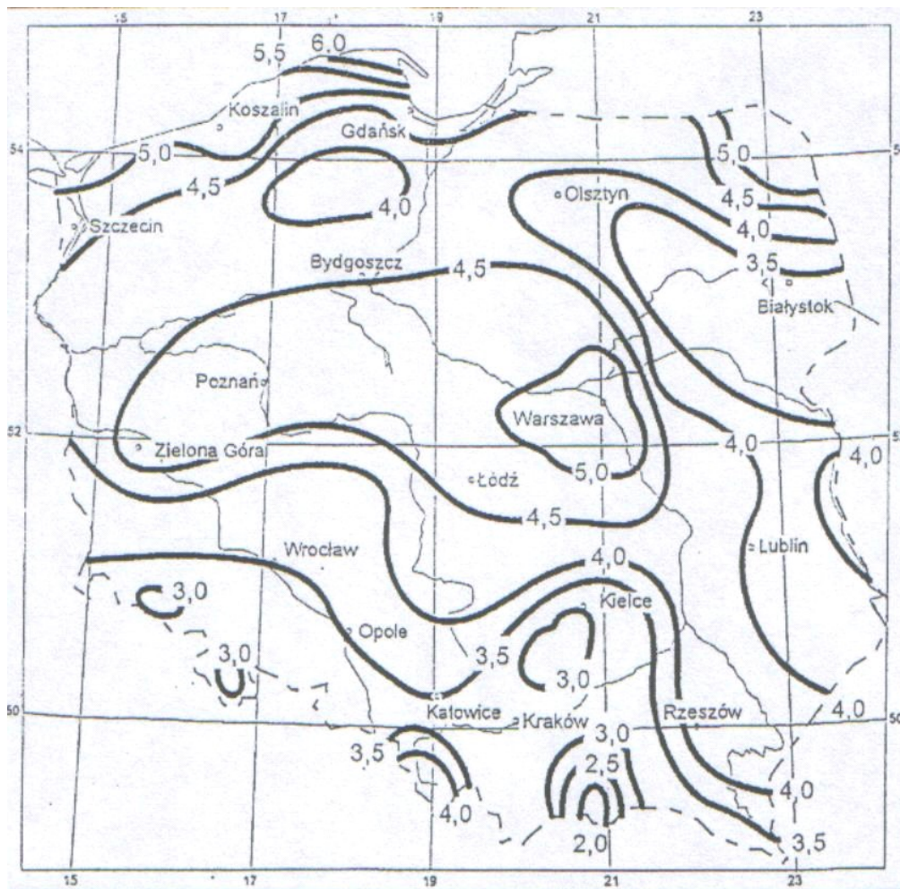
Rysunek 10.3. Średnioroczna prędkość wiatru (m/s) na wysokości ponad 30 m nad powierzchnią ziemi w terenie z przeszkodami do 3 m.
